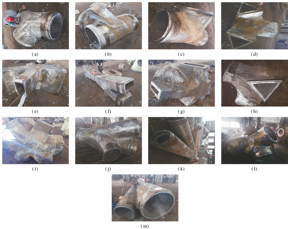
Fig. 2 Test specimens of complex cast steel joints. (a) F1; (b) F2; (c) F3; (d) F4; (e) F5; (f) F6; (g) F7; (h) F8; (i) F9; (j) F10; (k) F11; (l) F12; (m) F13
